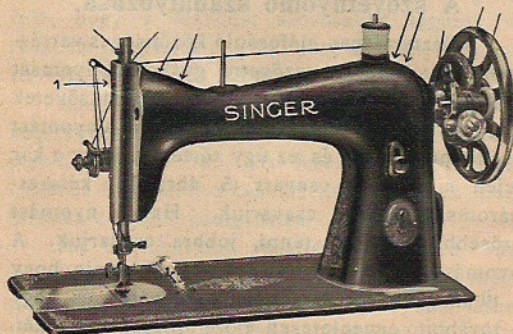
16. ábra. A gép elülső részén olajozandó helyek.
